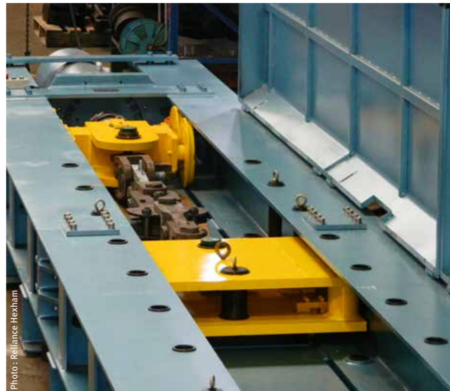
Le banc d'essai 200T, utilisé pour les essais destructifs et charges d'essais à des fins de validation des conceptions.
