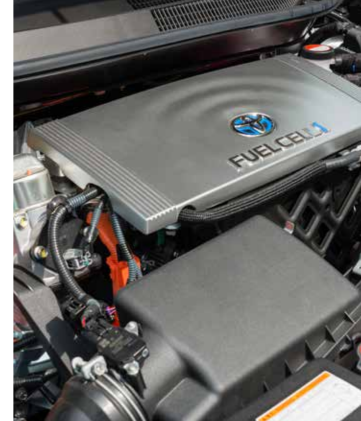
Le moteur de la Toyota Mirai, un véhicule à pile à combustible.
