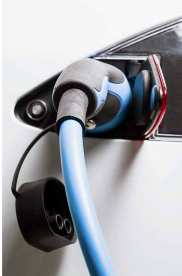
Les véhicules électriques doivent être équipés d'un dispositif standard pour le raccordement aux points de ravitaillement standards.
